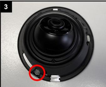
Variante 1 (versteckte Kabelzufuhr): Schwarze Abdeckung herausdrücken, damit das Kabel hindurch geführt werden kann.
